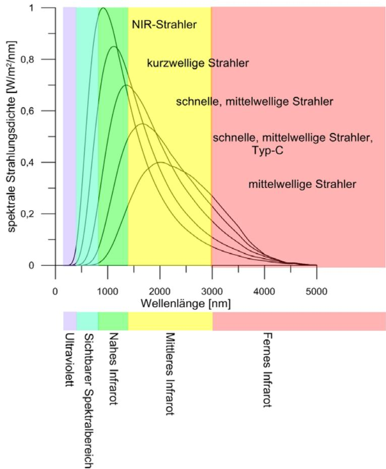
In Abhängigkeit vom Spektralbereich wirkt die Strahlung auf unterschiedliche Bereiche des Auges (Netzhaut, Hornhaut usw.) und der Haut. Je nach Strahlertyp, Strahlungsleistung und Anwendungsbedingungen (Abstand, Expositionszeiten, Abstrahlungsrichtung usw.) müssen geeignete Schutzmaßnahmen ergriffen werden. Die spektralen Leistungsanteile, die für unsere Strahlertypen typisch sind, können der folgenden Tabelle entnommen werden.
