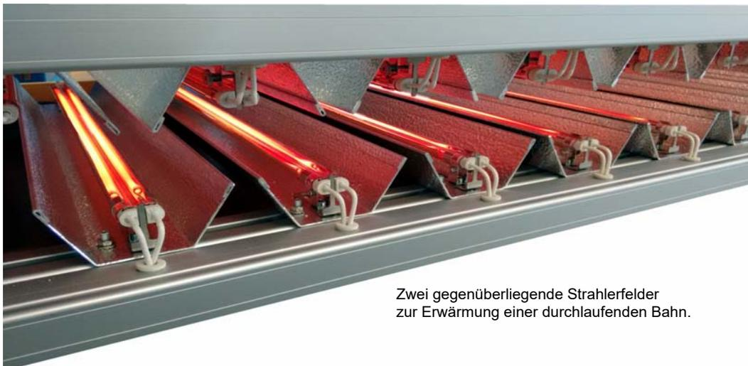
Zwei gegenüberliegende Strahlerfelder zur Erwärmung einer durchlaufenden Bahn.
