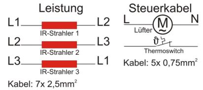
Alle Module werden mit 2m Silikon-Anschlusskabeln für Klemmenanschluss geliefert.
