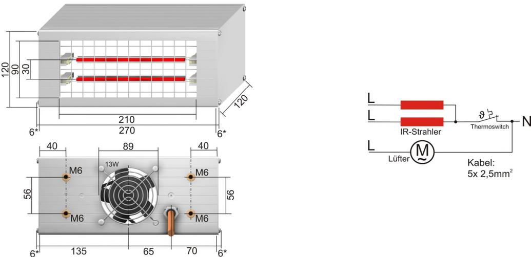
**IRD E270DSM** 3x 0,75 kW / 230 V (50/60Hz);
