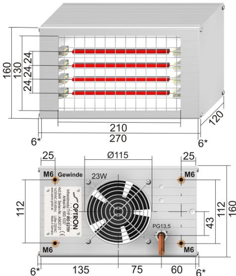
\* - Profilschnittsmaße zzgl. Seitenbleche (2mm) und Schraubenköpfe (4mm)
